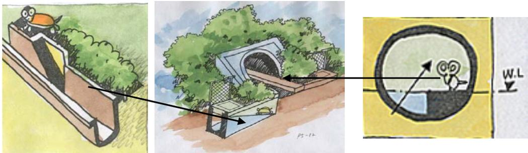
▲圖 3- 27 道路邊界溝渠 ▲圖 3- 28 小型動物及兩棲類動物移動管涵之設置概念圖
