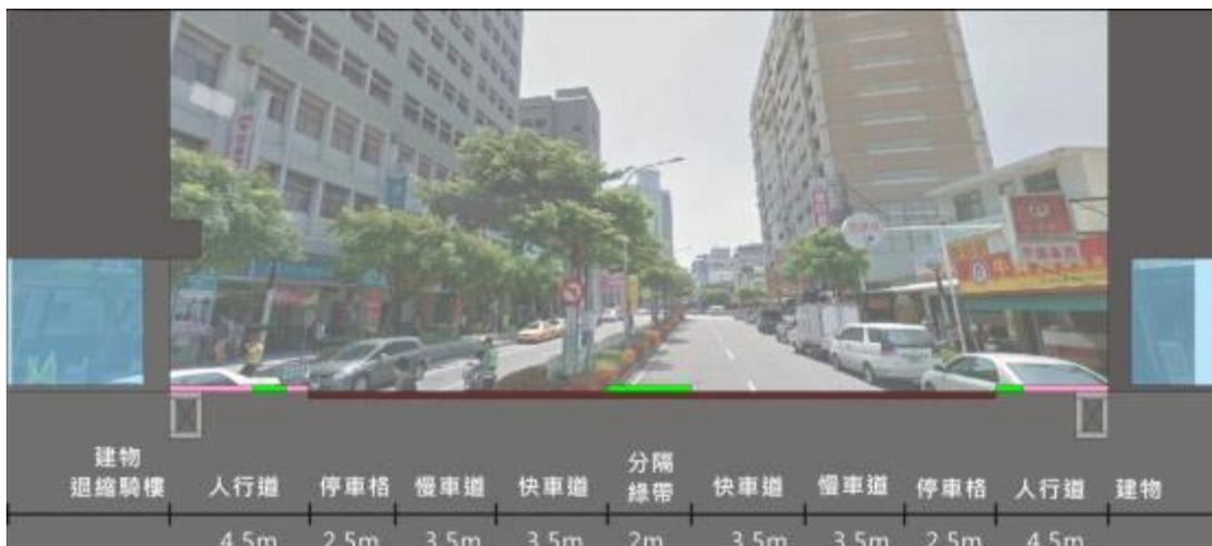
圖 21 旭光路（南校街-中山路）道路斷面示意圖
