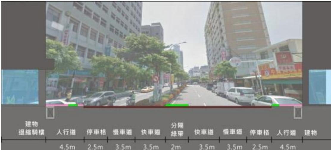
圖 22 旭光西路道路斷面示意圖
