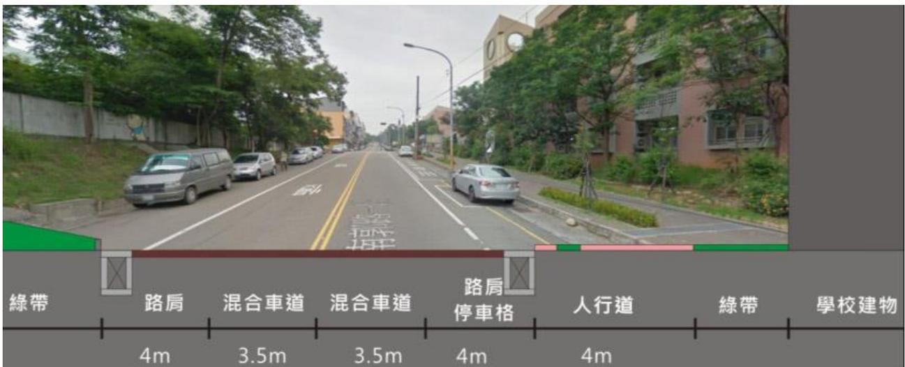
圖 28 南郭路一段學校部分斷面示意圖
