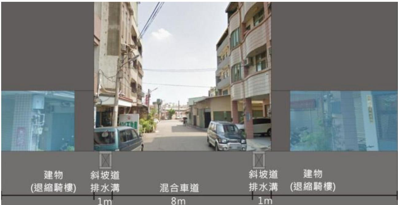
圖 14 和平路至民生路人行地下道道路斷面示意圖
